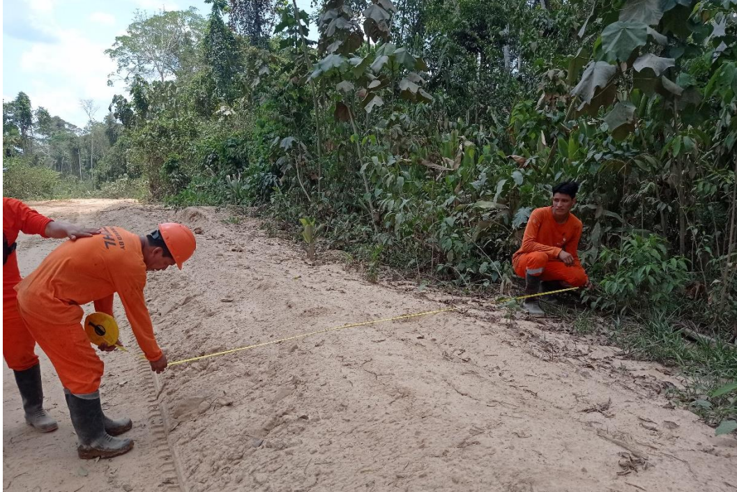
Figura 18. Medición del ancho del lateral del camino secundario de la PC 18.
